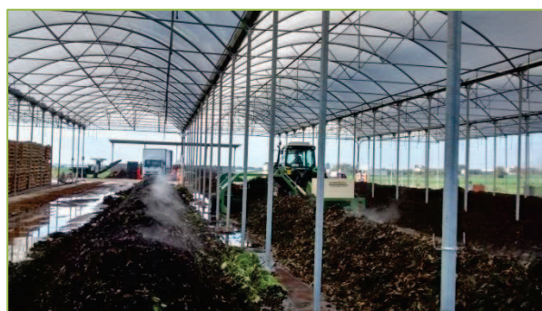
Figura 5 - Impianto di compostaggio on-farm presso l'azienda agricola Primaluce di Eboli (SA). Voltacumuli in azione.
